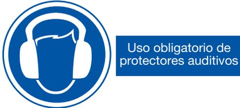
Figura 4 Ejemplo correcto de una señal indicativa aportando información complementaria a una señal tipo panel.
