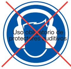
Figura 3 Ejemplo incorrecto de señal indicativa formando parte de una señal de panel.
